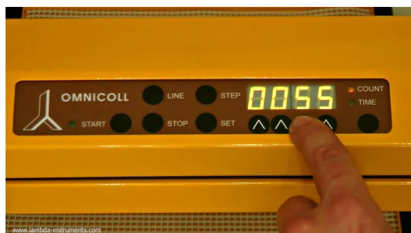
Рисунок 3.6-3 Выберите необходимое количество импульсов при помощи кнопки ▲ ▲ ▲ под дисплеем, например 55.
