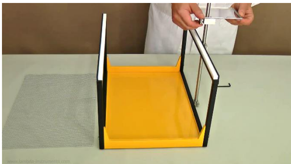
Рисунок 1.1-7 Проденьте металлический стержень через отверстия фиксирующих гаек и привентите данную конструкцию к правой раме при помощи болтов. Если необходимо прикрепите металлическую пластину.
