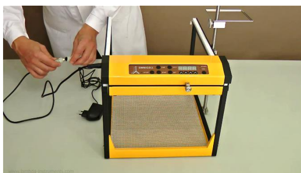
Рисунок 1.1-10 Соедините кабель блока управления коллектора фракций/сэмплера LAMBDA OMNICOLL с кабелем блока питания.
