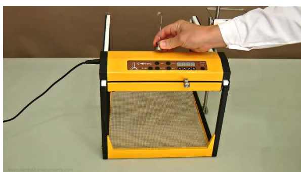
Рисунок 1.2-1 Установите магнитный держатель трубок в центре каретки коллектора фракций и блока управления.
