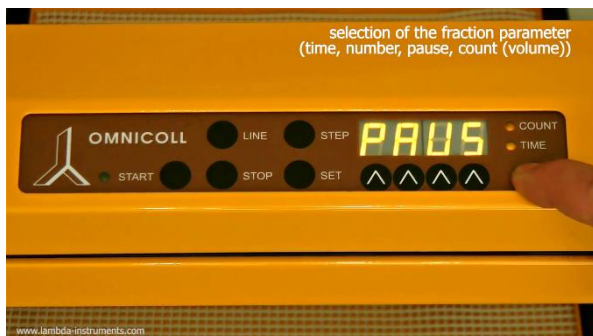
Рисунок 3.7-6 Выбор параметра PAUSE - задание паузы в программе. [Светодиод Count : ВКЛ.; Светодиод Time: ВКЛ.; Дисплей: PAUS]
