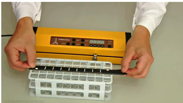
Рисунок 3.2-3 Поместите короткую, широкую магнитную кодировочную ленту в держатель оси X.
