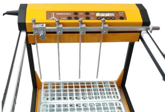
Рисунок 3.8-11 Установите держатель направляющих трубок так, чтобы он располагался над первой фракцией каждого потока (канала).
