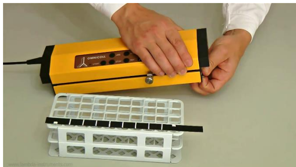
Рисунок 3.3-4 Вставьте кодирующую ленту в держатель оси X, а затем вставьте держатель вместе с лентой в предназначенное для них отверстие в блоке управления, белыми полосами наружу.
