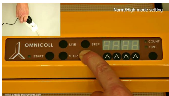
Рисунок 3.7-1 Нажмите кнопку SET на блоке управления и подключите блок питания к сети.
