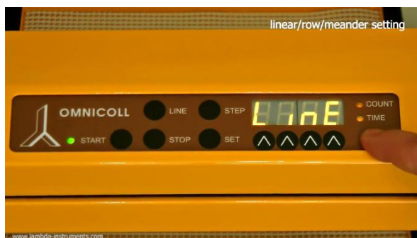
Рисунок 3.4-4 Обозначение “ Line ” (Линия), режим линейного сбора фракций.
