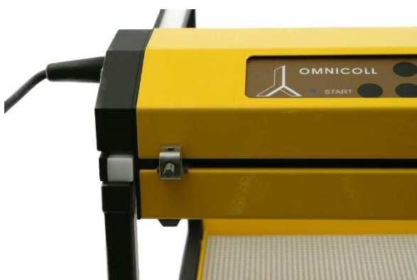
Рисунок 3.8-4 Отвинтите винт держателя направляющей трубки подвижной части коллектора фракций OMNICOLL
