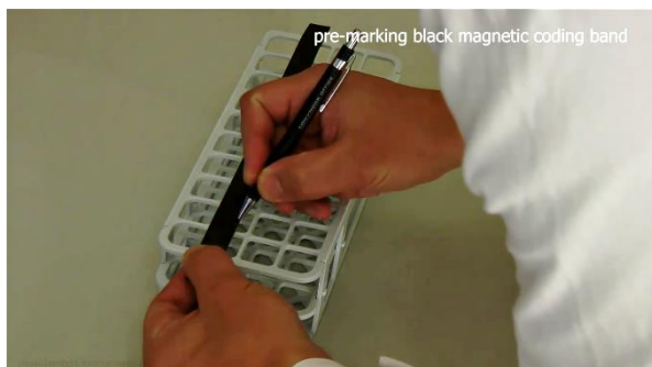
Рисунок 3.3-1 Положите кодировочные ленты на штатив для фракций и отметьте положение фракций обычным карандашом.
