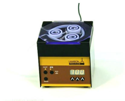
Рисунок 3.6-5 Выберите скорость (например, 700) и направление вращения перистальтического насоса, после чего включите насос.
