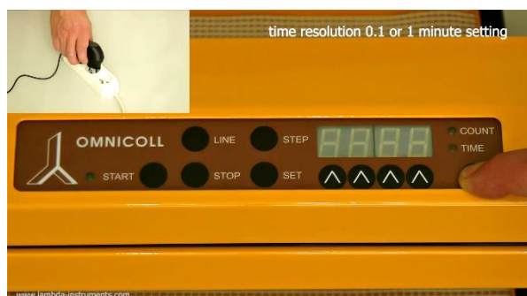
Рисунок 3.4-6 Подключите блок питания в сеть и одновременно нажмите кнопку COUNT/TIME
