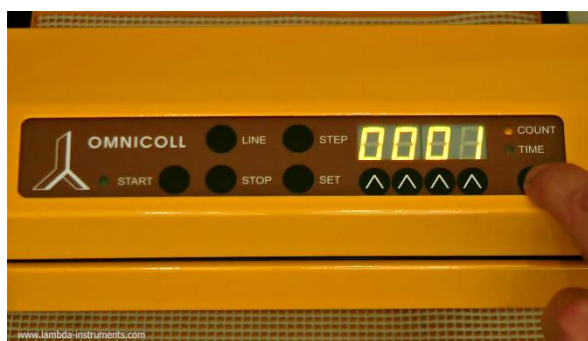
Рисунок 3.6-2 С помощью кнопки COUNT / TIME выберите режим COUNT (загорится светодиод COUNT)
