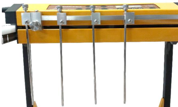
Рисунок 3.8-9 Наденьте направляющие трубки на держатель направляющих трубок и установите их на нужной вам высоте. Прикрепите направляющие трубки к держателю направляющих трубок при помощи шестигранного ключа.
