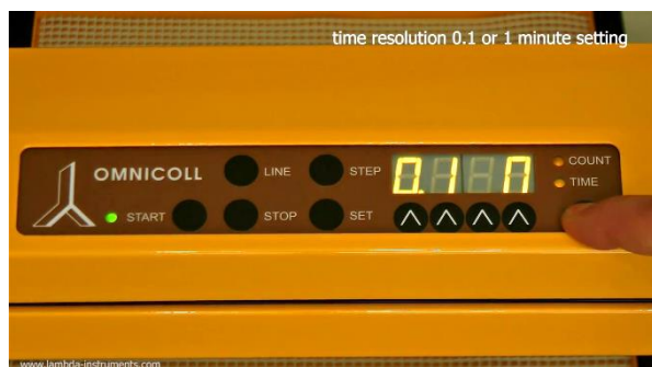
Рисунок 3.4-8 При нажатии на кнопку COUNT /TIME под светодиодами COUNT и TIME вы можете выбрать шаг в 0,1 мин ("0.1M") или в 1 минуту ("1M")
