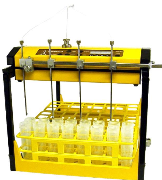
Рисунок 3.8-1 Пример сбора 4x2 фракций в 4- канальной комплектации
