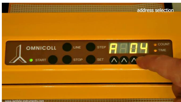
Рисунок 3.4-16 Чтобы изменить этот адрес нажмите кнопки ▲▲▲▲ под дисплеем, пока не появится нужный вам адрес.
