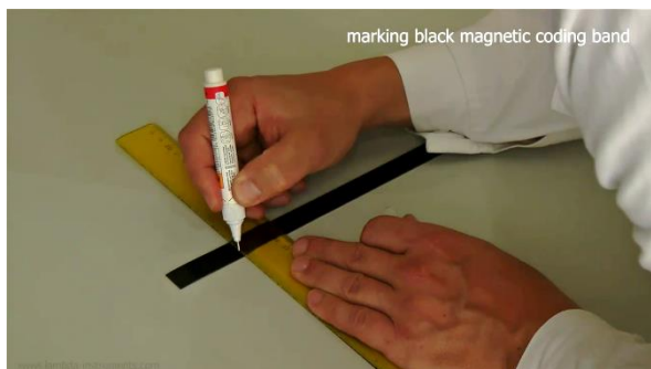
Рисунок 3.3-2 Теперь на уже помеченные места нанесите белые линии при помощи корректировочного карандаша. Оставьте приблизительно 2 см с обеих крѐв для первой и последней фракции.
