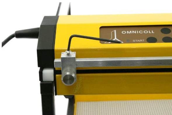
Рисунок 3.8-8 Закрепите держатель штанги на подвижной части коллектора фракций при помощи шестигранного ключа. Вы можете использовать тонкий (угловой) шестигранный ключ, чтобы протолкнуть винт через отверстие подвижной части коллектора.
