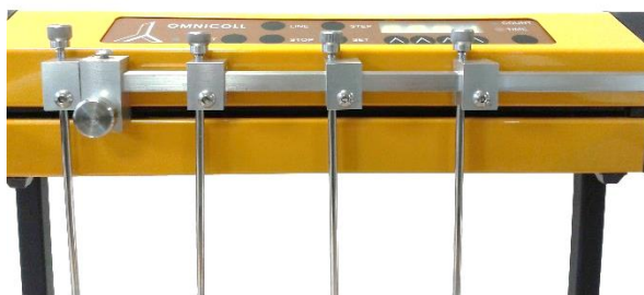
Рисунок 3.8-10 Поместите держатель направляющих трубок в нужное вам местоположение фракций и закрепите его при помощи винта с шестигранной головкой используя торцовый ключ.
