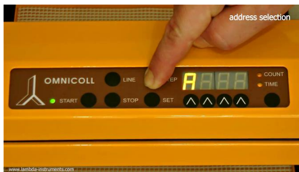
Рисунок 3.4-15 На дисплее появится буква "А" и две цифры. Этот номер от 00 до 99 является текущим адресом коллектора фракций.
