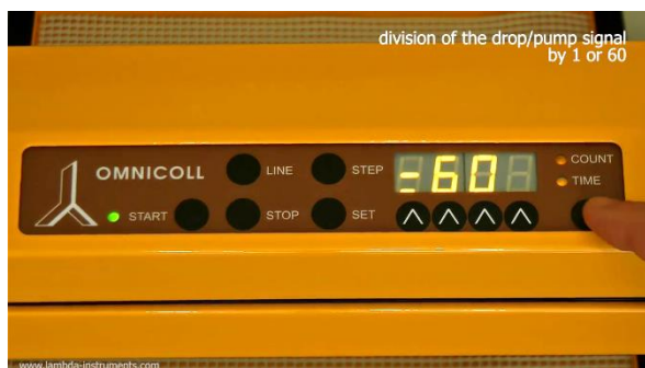
Рисунок 3.4-11 На дисплее появится обозначение "div" (делить), а затем "01" или "60"
