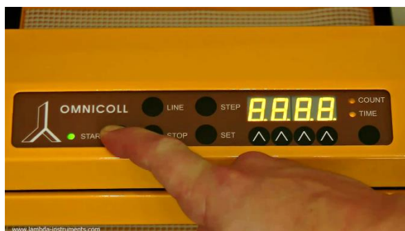
Рисунок 3.6-6 Нажмите кнопку START , чтобы начать фракционирование. Если трубка была неполностью заполнена жидкостью, например водой, возьмите вторую фракцию.
