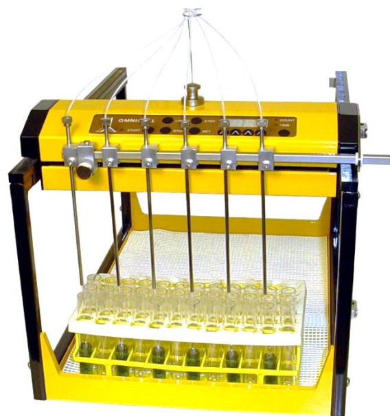
Рисунок 3.8-2 Пример сбора 6x2 фракций в 6- канальной комплектации
