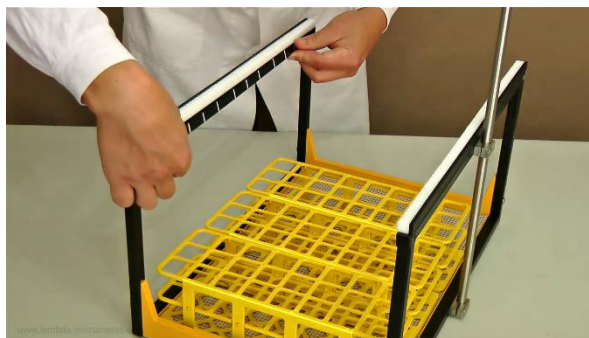
Рисунок 3.3-6 Поместите кодирующую ленту с внутренней стороны левой металлической рамы под зубчатыми рельсами.
