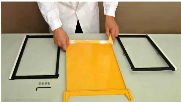
Рисунок 1.1-1 Вставьте держатель рамы в пазы желтой консоли-подставки с боковой короткой стороны
