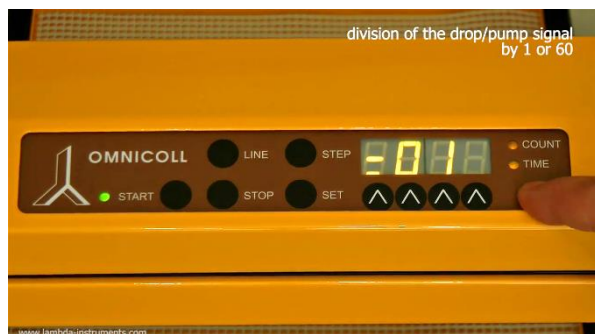
Рисунок 3.4-12 Выберите нужный коэффициент деления нажатием на кнопку COUNT/TIME
