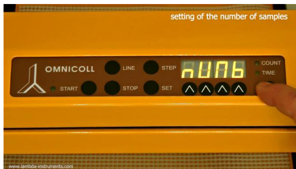
Рисунок 3.7-7 Выбор параметра NUMBER - количество собираемых фракций [Светодиод Count: ВЫКЛ.; Светодиод Time: ВЫКЛ.; Дисплей: nUMb]
