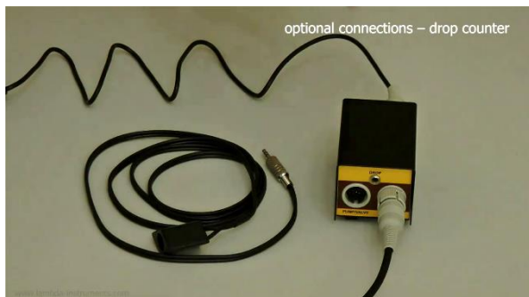
Рисунок 1.3-1 На рисунке показаны кабель счётчика капель (детектор) и коммуникационный модуль. (Арт. № 6929)
