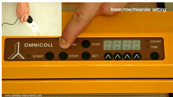
Рисунок 3.4-1 Подключите блок питания к сети и одновременно нажмите кнопку LINE (ЛИНИЯ)
