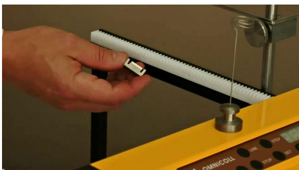
Рисунок 1.1-11 На правой внутренней стороне рамки установите имеющийся в комплекте магнит для остановки коллектора фракций.
