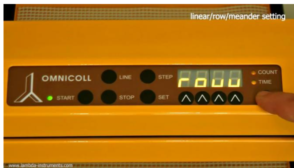
Рисунок 3.4-2 На дисплее появится обозначение row (РЯД), т.е режим сбора фракций по рядам. Чтобы выбрать нужный режим нажмите кнопку SELECTION (ВЫБОР), которая находится под кнопками COUNT / TIME
