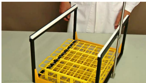
Рисунок 3.3-5 На кодирующей ленте оси Y отметьте расстояние между рядами фракций сначала простым карандашом, а затем нанесите белые линии имеющимся в комплекте корректировочным карандашом.
