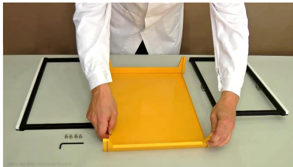
Рисунок 1.1-2 Затем вставьте второй держатель рамы в пазы консоли-подставки с другой стороны.
