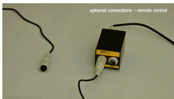
Рисунок 3.6-1 Подключите кабель дистанционного управления перистальтического насоса к коробке коммуникационного модуля.
