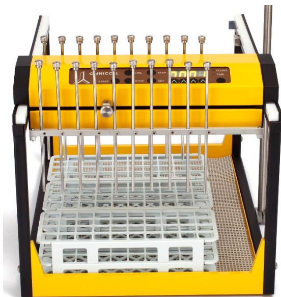
Рисунок 3.8-3 Пример одновременного сбора 20 фракций в 20-канальной комплектации
