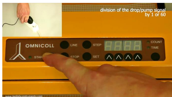
Рисунок 3.4-10 Подключите блока питания к сети одновременно нажмите кнопку START
