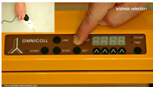
Рисунок 3.4-14 Удерживая кнопку STEP в нажатом положении подключите блок питания к сети.
